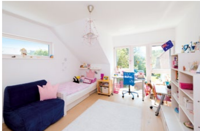
In den Kinderzimmern sollte es ursprünglich nur ein großes Fensterelement geben. Dann hätten jedoch Geländer wegen Absturzgefahr vorgesehen werden müssen. Die Lösung: Die unteren Glaselemente sind fest, nur die oberen können geöffnet werden.
